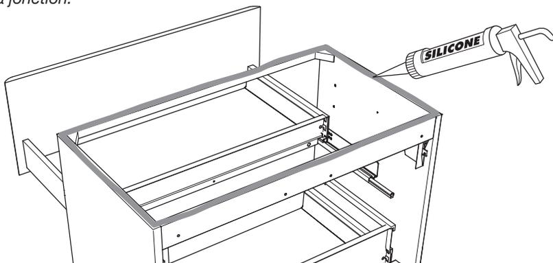
**Deuxième étape :** Appliquer un cordon de joint silicone régulier aux jonctions plan vasque / caisson et plan vasque / mur. Lisser au doigt ou à la spatule. Laisser sécher selon la durée adéquate (se référer aux données fournies par le fabricant sur la cartouche de silicone).
